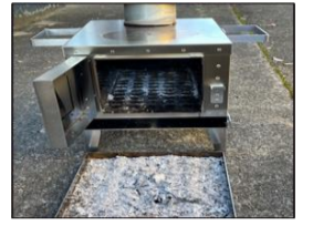
①完全燃焼しました。 ②吸い込み弱い=煙突を長くして対応することに。
