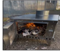
①完全燃焼しました。 ②吸い込み弱い=煙突を長くして対応することに。
