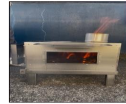
①完全燃焼しました。 ②吸い込み弱い=煙突を長くして対応することに。
